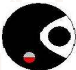
LPG - Резерв (мигает красный диод)
